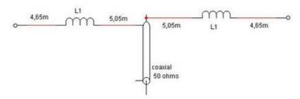
Esta mesma antena poderá ser cortada para 40 e 80 metros. A parte central terá 10,04 metros de fio e a ponta terá 1,60 metros. As bobinas são feitas no mesmo tipo de tubo, porém com 120 espiras unidas de fio encapado de 1,5 mm (aproxmadamente 115 uH). Ajuste primeiro a parte interna para 40 metros e depois a parte externa, para os 80 metros.
