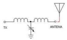
BOBINA - tubo de 50 mm de diâmetro. Enrolar 20 espiras de fio grosso (# 16) com pequeno espaçamento entre as espiras. Fazer derivação para o capacitor na 10º espira. Para 80 metros adicionar 5 espiras de cada lado, ficando um total de 30 espiras. Com uma chave pode-se comutar de 40 para 80. CAPACITOR VARIÁVEL - de 400 a 500 pF. Pode ser um variável duplo de recepção, com as glasses esções ligadas em paralelo. CAIXA metálica com os dois conectores coaxiais.
