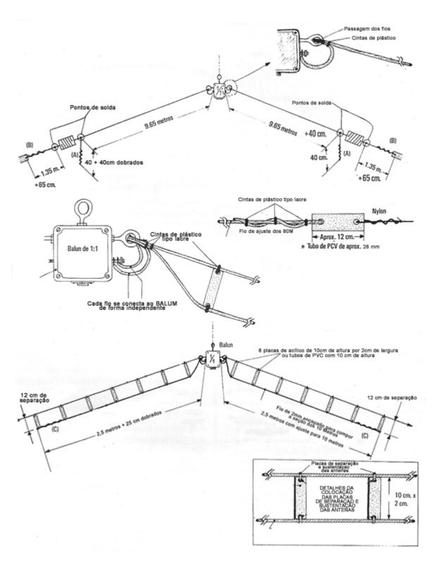
**E os 20 metros? como incluir?** Segundo o autor, a inclusão da banda dos 20 metros, é feita da mesma maneira que se incluiu a dos 10 metros, ou seja, colocando-se separadores com especificações idênticas aos utilizados para os 10 metros e instalando-se os fios abaixo da banda dos 10 metros. Ficaria então, com uma distância de 10cm dos fios de 10 metros e 20cm dos fios da banda de 15
