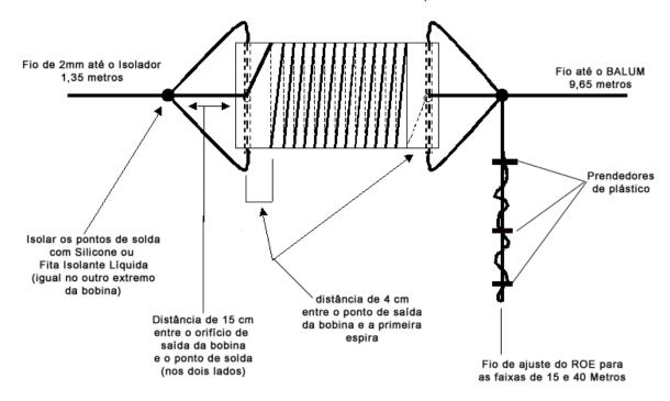
**2)** Corte dois pedaços do fio de 2mm com 10,45 metros e prenda as pontas no isolador central conforme demonstrado na figura abaixo, as outras duas pontas solde nas bobinas.
