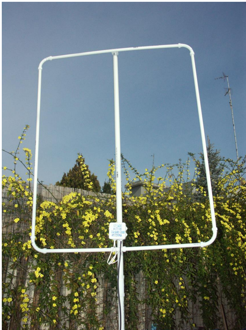
Foto 7 – Vista Antenna Attiva Square Loop per ricezione. La misura degli elementi verticali e' di 130cm e di quelli orizzontali di 106cm, per un perimetro totale intorno ai 4.50 metri, piu' o meno il doppio della circonferenza della Hula-Hoop.
