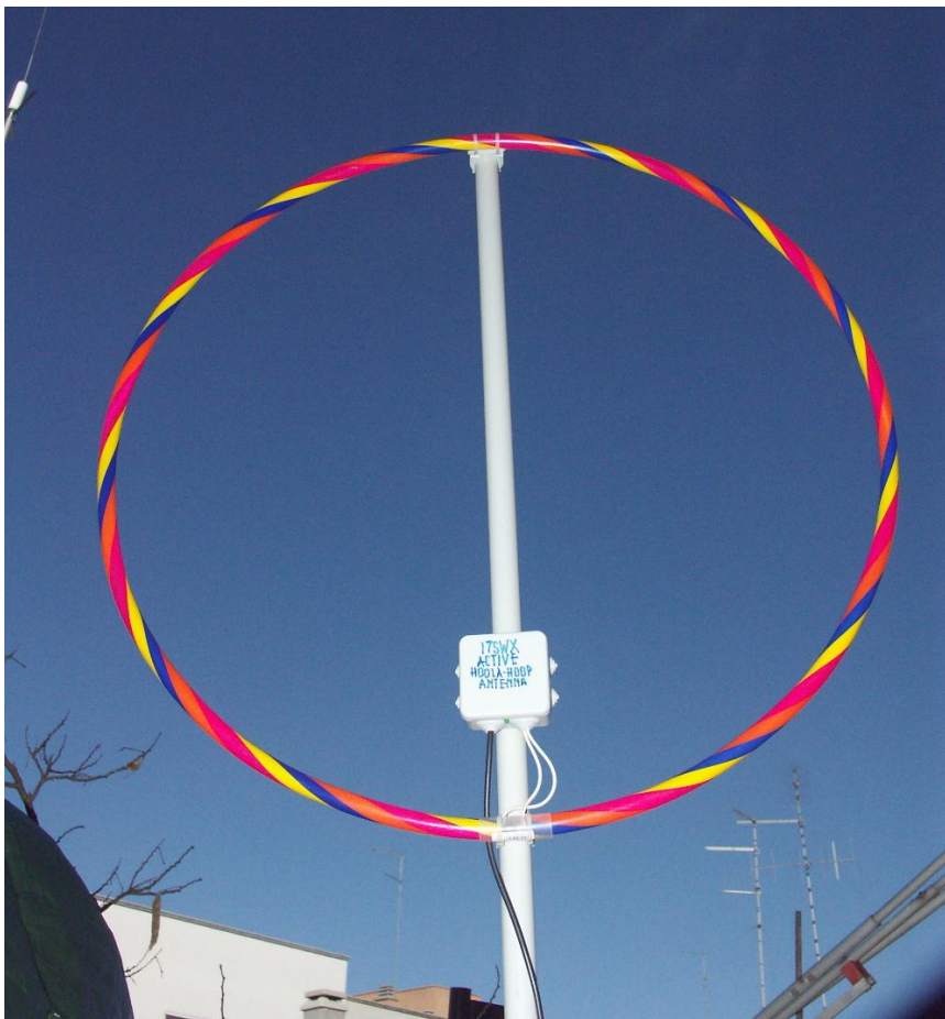
Foto 1 – Vista Antenna Attiva Hula-Hoop per ricezione SWL. La configurazione come in foto e' valida per una sperimentazione ma meccanicamente non e' delle piu' robuste. E' consigliata una configurazione square loop ridotta con lati di circa 80-90 cm.
