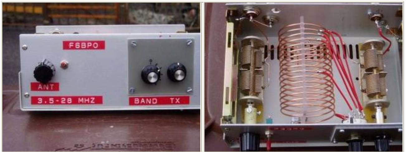
La comparaison des deux photos permet de faire la relation avec le schéma de câblage. Les CV sont isolés de la masse et la commande de leur axe se fait au travers d'un manchon isolant. La sorte antenne se fait soit sur une prise coaxiale, soit sur une fiche banane selon le type d'antenne utilisé.
